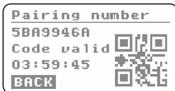
**Parear novo (Pair new):** É usado para parear um novo dispositivo. A tela do número de pareamento aparece e o LED azul pisca rapidamente. O pareamento próximo ou remoto agora pode ser realizado.
