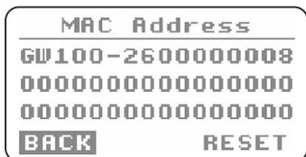
Ao selecionar RESET, todos os gateways pareados podem ser excluídos do sistema de cerca, o que também altera o endereço MAC da cerca. Isso significa que o gateway não poderá enviar ou receber dados do eletrificador. A função é usada para remover o eletrificador do gateway, por exemplo, ao vender a cerca, para que o proprietário original não possa controlar o novo eletrificador do proprietário através do aplicativo Cloud.
