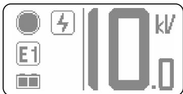
A mensagem de erro E1 - erro na avaliação da tensão de saída - pode aparecer na tela básica. Essa condição indica que o sistema de cerca não está funcionando corretamente. A potência do eletrificador é limitada a 5 J e a medição de aterramento não funciona. Esta condição pode ser causada por vários motivos. Portanto, neste caso, é necessário entrar em contato com a loja física ou virtual onde adquiriu o produto para verificar como proceder caso necessitar de Assistência Técnica ou garantia.
