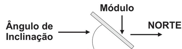
O Painel deve ser orientado para o Norte (quando a instalação for no hemisfério sul). O ângulo de inclinação varia com a latitude do lugar da instalação:
